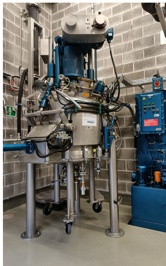
Πιλοτική κλίμακα εκχύλισης: πρωτότυπη παραγωγή για την επιβεβαίωση των πρωτοκόλλων εκχύλισης που καθιερώθηκαν σε εργαστηριακή κλίμακα.
